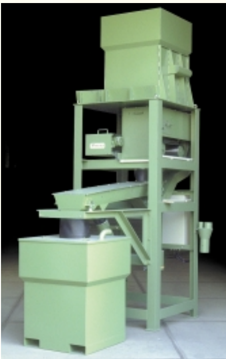
Schweißpulveraufbereitungssystem zur Separierung von Über- und Unterkorn
