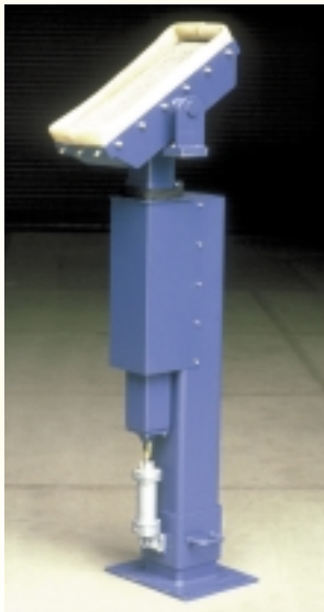
Pulverstütze für die Innenschweißung geeignet für intermittierende Betriebe
